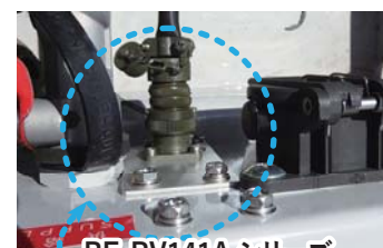
BE-RV141A シリーズ ケーブルジョイント接続部
