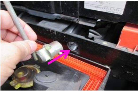
固定金具を上記写真 矢印方向入れ矢印方向へ反時計回りに回し取り付ける
