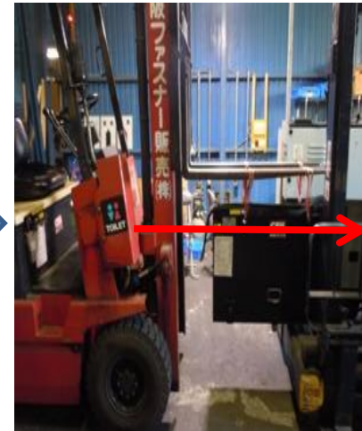
バッテリーを吊り上げ慎重に後退しバッテリー置きます。 *引き出す際、補助員はバッテリーと車体が当たらないか確認し、運転者を誘導して下さい
