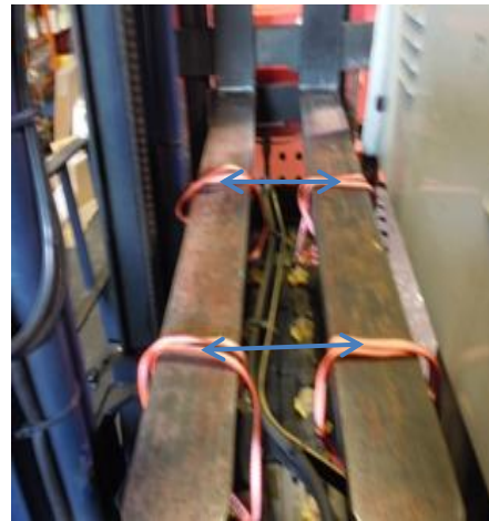
吊り上げ時同様に、ロープの位置を調整します
